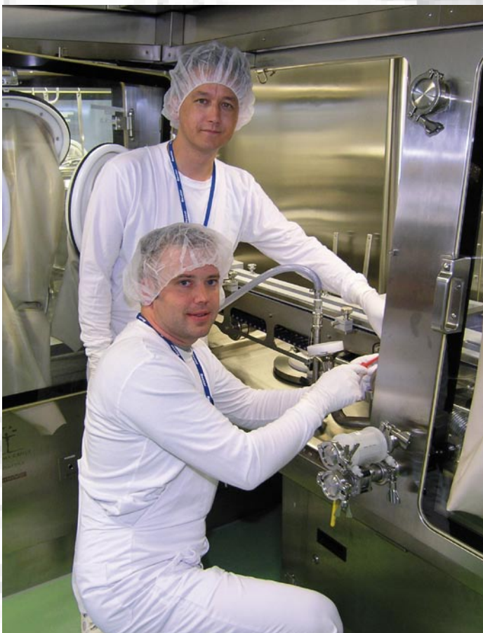
Torsten Wittke und Alexander Wähler bei Einstellarbeiten am Entladeisolator GT3
